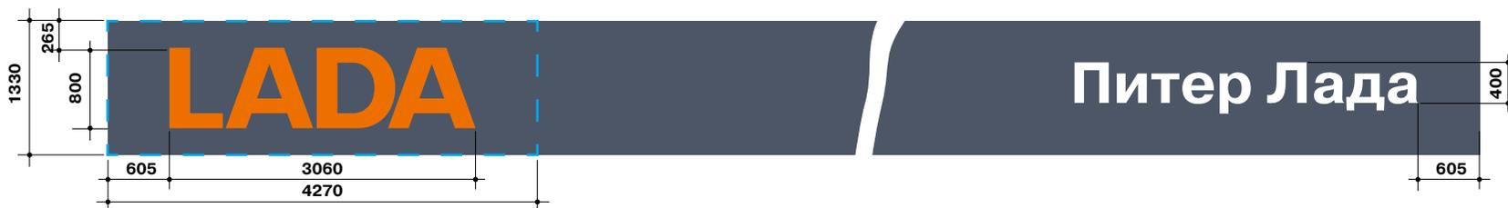
3. Фасадная система с высотой логотипа 1250 мм применяется для фасадной полосы высотой не менее 2100 мм. Логотип и наименование дилера располагаются по горизонтали симметрично друг другу.
