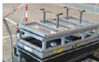
Support de guidage des batteries Référence MPR : n° 7711381968
